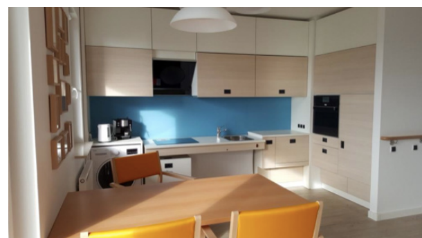
Fot. 5. Widok na kuchnię. Zaprojektowano niezabudowany blat roboczy z możliwością jego obniżania. Autor: Agnieszka Cieśla, 2016.
