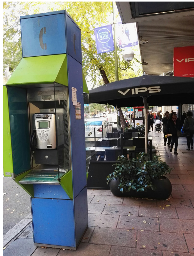
↑→ Fot.17,18 Budka telefoniczna dostosowana wysokościowo do potrzeb osób na wózkach inwalidzkich, Madryt. Autor: Agnieszka Labus, 2016.
