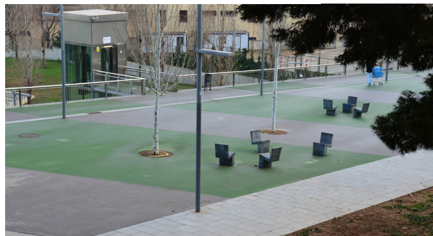
↑ Fot.10 Zastosowanie zróżnicowanych faktur i kontrastów kolorystycznych na posadzce dla wydzielenia strefy rekreacji i wypoczynku – dzielnica Nou Barris w Barcelonie. Autor: Agnieszka Labus, 2016.
